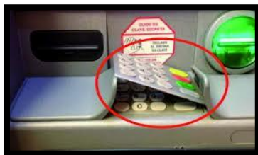
2 EL ENGANO Falso lector. La aparente normalidad del cajero oculta una ranura falsa, pegada sobre la original, con los mismos colores y calcomanía. Este aparato contiene un lector de tarjeta que copia los datos de la cinta magnética. Luego, los delincuentes duplican el plástico.
