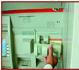
2 EL ENGANO Falso lector. La aparente normalidad del cajero oculta una ranura falsa, pegada sobre la original, con los mismos colores y calcomanía. Este aparato contiene un lector de tarjeta que copia los datos de la cinta magnética. Luego, los delincuentes duplican el plástico.
